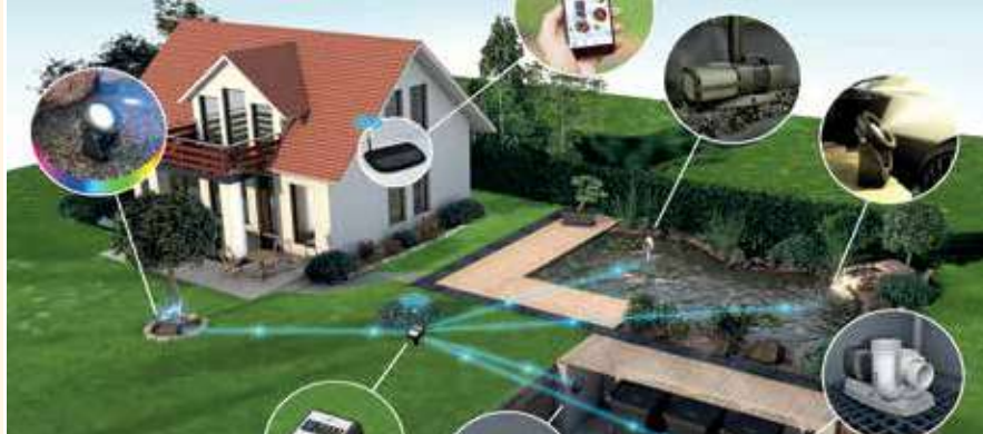
Schematisk beskrivning: InScenio EGC Controller kopplad till router och EGC-kompatibla OASE-slutanvändarenheter
