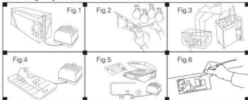
Bild 1: Luftversorgung im Aquarium. Bild 2: Lüftung zum trocknen von Kleinteilen in der Industrie. Bild 3: Belüftung von medizinischen Geräten. Bild 4: aufpumpen einer Luftmatratze. Bild 5: Vakuum Verpackung. Bild 6: Reinigung von Produkten.
