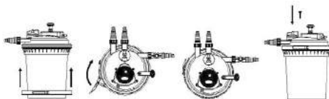
Lukning af filter med placering af spændering / Placering spännring vid låsning av filter
